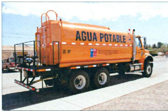
La Inversión de camión aljibe de 20 m<sup>3</sup>, con estanque de acero inoxidable, con el siguiente detalle y generalidades: potencia: mínimo 350 hp a rango (1900 – 2.100 r.p.m) torque: 1.350 lb/ft a 1.100 r.p.m transmisión caja de cambio.
